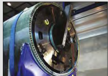
▲ Fresadoras orbitales para la fabricación de turbinas eólicas.
