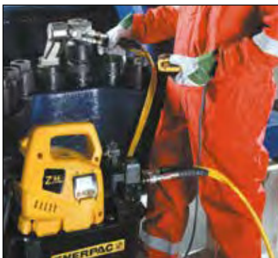
◀ Las bombas para llaves dinamo métricas de la serie ZU4 pueden accionar cualquier marca de llaves dinamo métricas hidráulicas.
