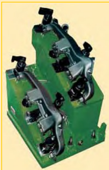
Dispositivo para el maquinado de múltiples de escape.
