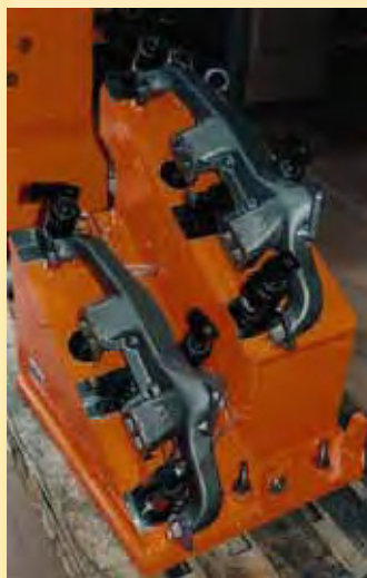
Las cilindros de amarre giratorios MPTL-100 y MPTR-100 Collet-Lok® se utilizan para sujetar de manera segura estos colectores múltiples de escape.
