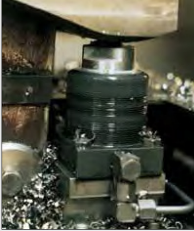
Foto: WFL-221 sosteniendo en posición una pieza de fundición.
